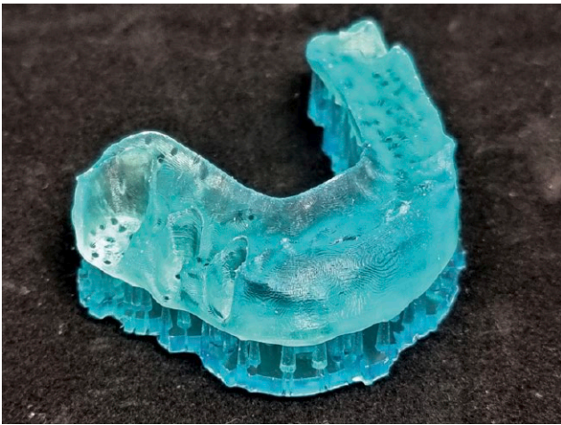
18.2 und 19 Das aus VarseoWax Surgical Guide (Bego) gedruckte Registrat wurde mit Wachs um einen Millimeter erhöht, um ein freies Einbeissen zu gewährleisten
