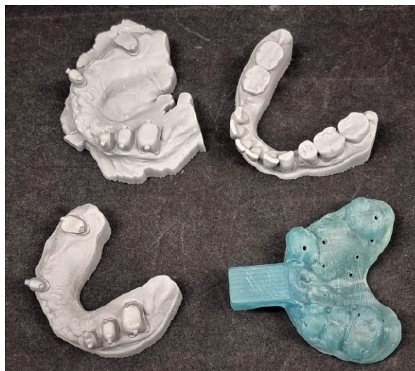
14 Die Herstellung von Modellen, Primärkronen sowie des individuellen Löffels im 3D-Druck-Verfahren
